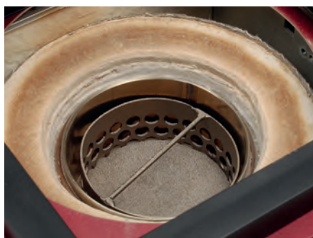
■ Vista della camera di pulizia (sinistra). La capacità del cestello di 25 cm 3 è sufficiente per pulire 24 punte HPS III-MH (destra)
